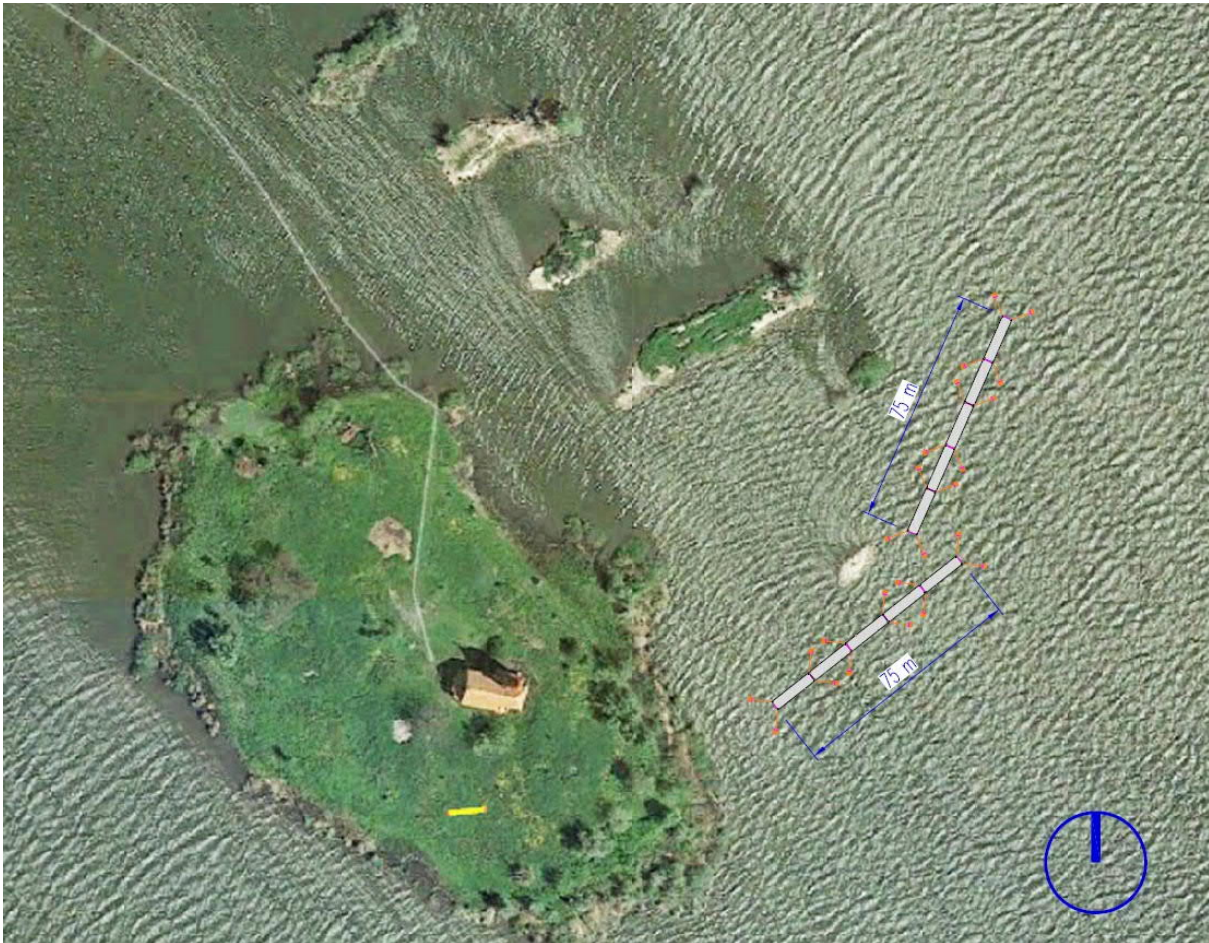
Obr.G.2: Návrh umístění soustavy plovoucích ostrovů jako ochrany ostrovů proti abrazi a současně vhodné hnízdní plochy. (Povodí Moravy, 07/2020)
